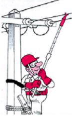
La versión para instalaciones de alta tensión sustituye los bornes por una pértiga con mango aislado, con una pinza en un extremo para establecer contacto con la línea (generalmente elevada) y un conductor flexible y otra pinza en el otro extremo para establecer la conexión a tierra (ilustración de la web de la Asociación para la prevención de accidentes APA)
