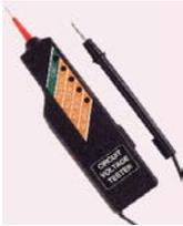
Un detector de tensión más simple, llamado buscapolos, indica si un conductor está o no bajo tensión, usando el cuerpo del operador como puente a tierra, mediante una resistencia y una lámpara, que se ilumina si el conductor está bajo tensión. Sólo puede usarse en instalaciones de baja tensión.
